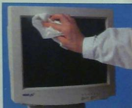
12 Компьютер не следует включать раньше чем через час, чтобы обработанные вами поверхности как следует высогли. Включив компьютер, воспользуйтесь набором для чистки дисководов, следуя прилагаемой к нему инструкции. Вот и все. Можно отдохнуть, пообщаться с результатами своего труда и с удовольствием приступить к работе на чистой машине.
