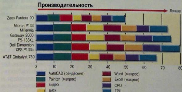
В тестах на реальных приложениях лучшим оказался ПК Dell Dimension. Его высокое быстродействие объясняется использованием видеодаттера Numtek Nine Imagine-128 и быстрого ХММД Quantum Fretail со скоростью вращения шпинделя 5400 об/мин, поддерживающего режим PIO Mode 4. Машины фирмы Gateway 2000 и Micron были практически такими же быстрыми. В этих
