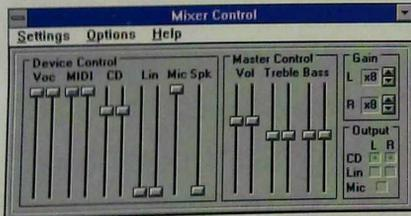
Встроенный в плату Sound Blaster 16 программно-управляемый микшер позволяет смешивать синтезируемые платой звуки с внешними сигналами, поступающими от компакт-диска, линейного входа, микрофона и динамика машины.
