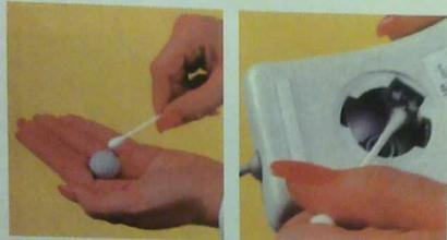
5 Смочите ватный тампон в спирте и протрите им шарик, затем осторожно протрите ролик внутри мыши. Оставьте шарик и мышь полежать минут 10–15, чтобы они высогли.
