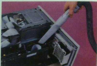
10 Вооружившись пылесосом, осторожно удалите оставшуюся пыль с внутренних компонентов компьютера. Ни в коем случае не касайтесь наконечником печатных плат! Их легко повредить! По окончании чистки поставьте крышку корпуса на место.
